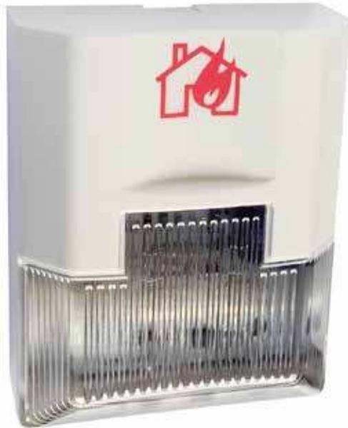
Dans le cadre de l'article GN-8 du règlement Sécurité Incendie des ERP, le diffuseur lumineux permet de signaler une évacuation incendie d'une manière visuelle et ainsi de tenir compte de la spécificité de l'handicap des personnes malentendantes amenées à être isolées dans une partie du bâtiment.
