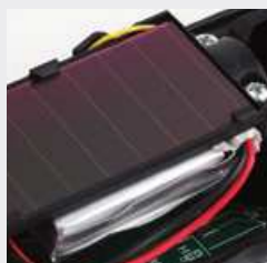
FONCTIONNEMENT COMBINÉ BATTERIE-PANNEAU SOLAIRE
