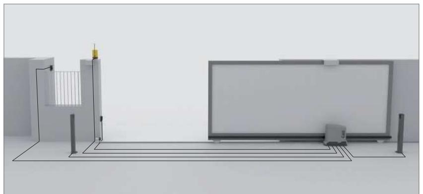
L'installation représentée ne comprend pas les dispositifs de sécurité (par exemples les barres palpeuses, etc.) qui sont ajoutés en fonction de l'«analyse des risques» spécifique de chaque installation comme prévu par les normes EN 12445-12453.
