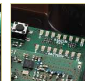
8 LEDS ROUGES - ÉTAT DES SÉCURITÉS 8 LEDS VERTES - NIVEAU DE CHARGE
