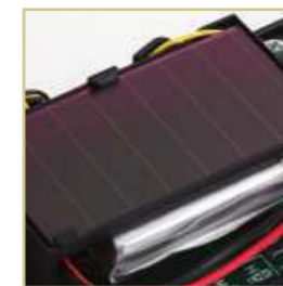
FONCTIONNEMENT COMBINÉ BATTERIE-PANNEAU SOLAIRE
