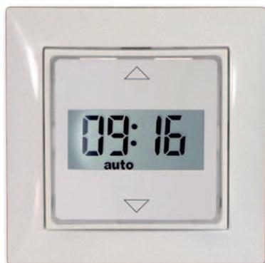
Le QCK2H est un module exclusivement destiné à la commande de volets roulants et de stores, intégrant une horloge journalière et un écran d'affichage. Le QCK2H doit toujours être sous tension pour maintenir sa programmation : en cas de panne de courant, la programmation existante est conservée pendant 2 minutes pour compenser d'éventuelles micro-coupures dans le réseau électrique. Il peut être utilisé comme une commande individuelle ou de groupe pour plusieurs produits motorisés.
